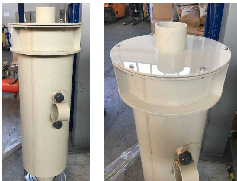
Esempio di unità filtrante a servizio degli sfiati dei serbatoi percolato
