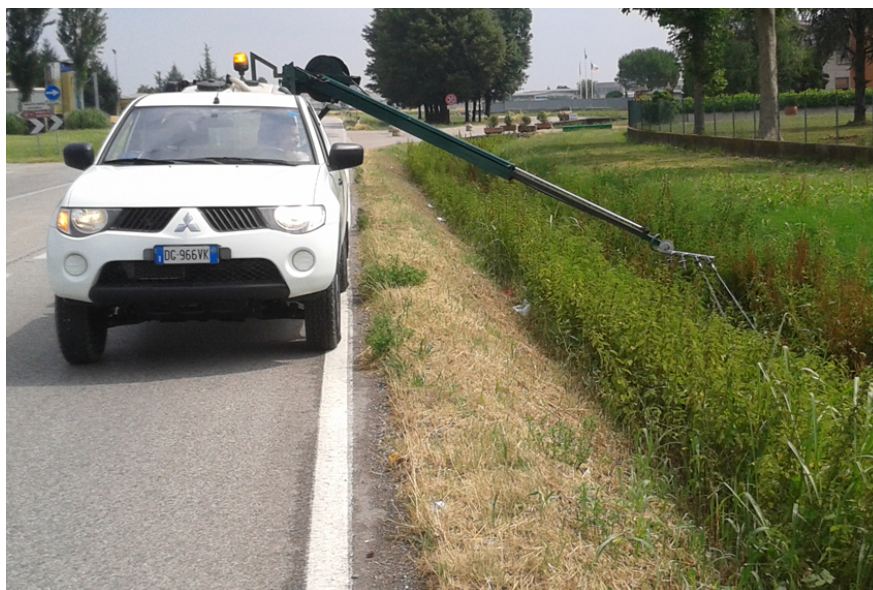
Fig. 02– Pick-up con il braccio pneumatico in azione
